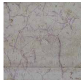
Dissolution observée sur une pierre
